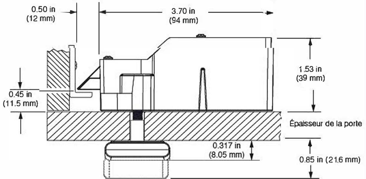
*Présenté avec un mécanisme de verrouillage avec pêne demi-tour.*
