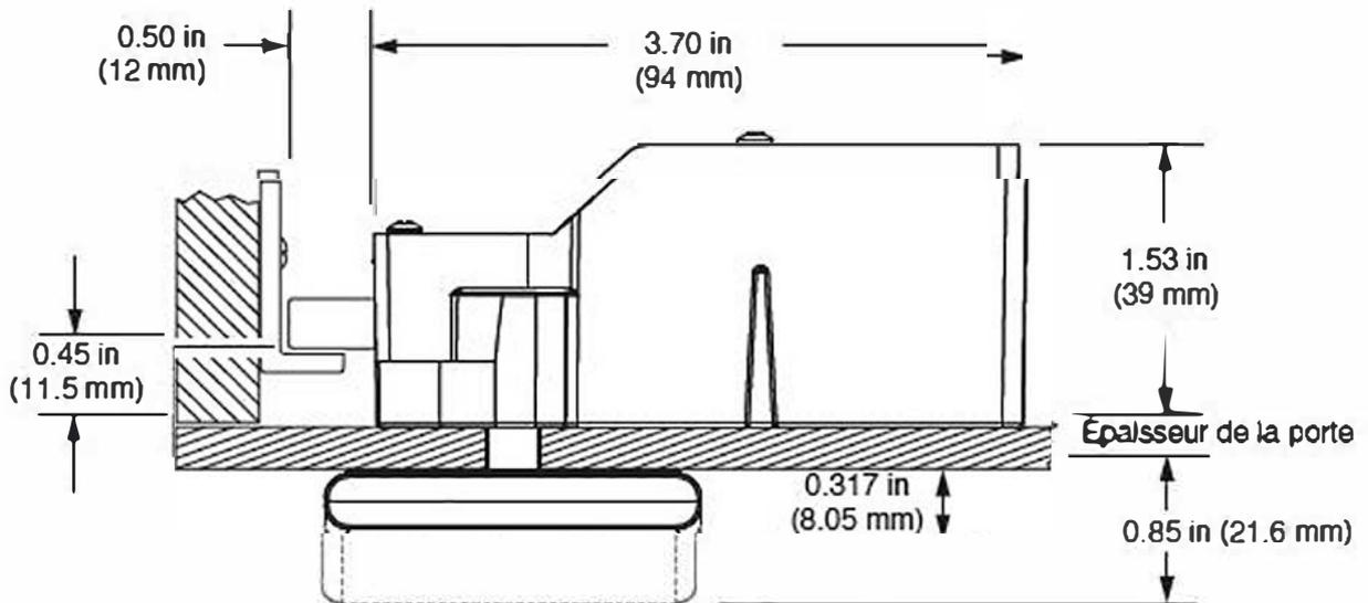
*Présenté avec un mécanisme de verrouillage avec pêne dormant*
